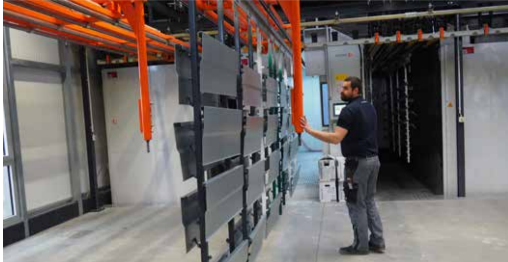
Blick in die Fertigung: In der Anlage können 6m lange Werkstücke aus Aluminium und verzinktem Stahl beschichtet werden. Hier werden die aufgehängten Teile in die Pulverkabine transportiert (li.) und dann manuell gepulvert.
