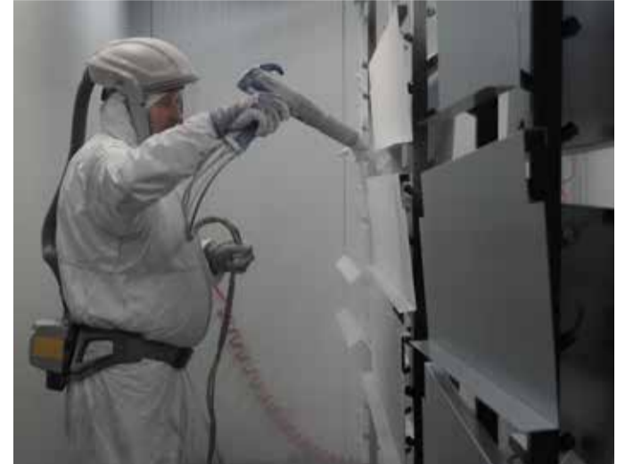
Blick in die Fertigung: In der Anlage können 6m lange Werkstücke aus Aluminium und verzinktem Stahl beschichtet werden. Hier werden die aufgehängten Teile in die Pulverkabine transportiert (li.) und dann manuell gepulvert.
