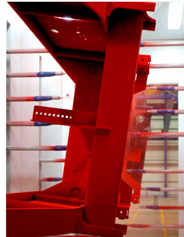
Mit dem Dynamic Contouring System und der weichen Pulverwolke der Dichtstrom-Technologie des Encore HD Sprühsystems wird eine hervorragende Oberflächenbeschichtung erzielt.
