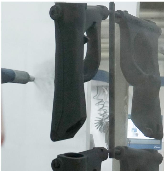
besserung ist in vollem Umfang eingetreten.“ Der Oberflächen-Spezialist führt das auf die sehr gleichmäßige Verteilung des Pulvers selbst auf komplex geformten Bauteilen infolge der weichen Pulverwolke zurück, die mit nur geringer Geschwindigkeit und aus geringem Abstand aus der robotergeführten Pulverpistole austritt: Geringe Rücksprüheffekte, eine hohe Eindringtiefe des Pulvers sowie minimaler Overspray sind typisch für die Nordson Dichtstrom-Technologie.
