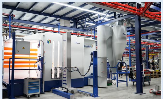
Die Kabine, Pulverpistolen und Pulverzentrum bilden ein Farbwechsel-System, für das täglich etwa acht weitgehend automatisierte, minutenschnelle und verschleppungsfreie Farbwechsel geplant sind.
