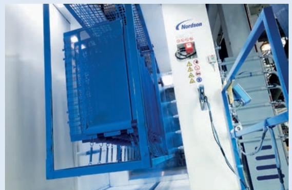
Zu den Kennzeichen der eingesetzten Dichtstrom-Technologie zählen eine sehr weiche Pulverwolke sowie eine sehr gute Deckung bei Vertiefungen. Sie ermöglichen die hochwertige Beschichtung der Lochbleche.
