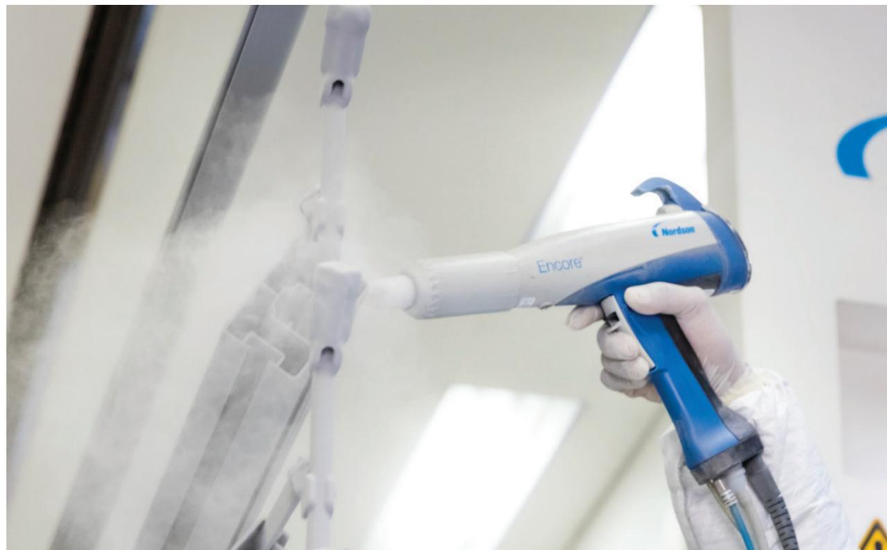
Rund um die leistungsstarken Encore HD Handpistolen bietet Nordson ein komplettes, vielseitiges System, das diese Beschichtungseinheiten neben der Festinstallation (an der Wand oder auf einer Hutschiene) und der Stand-alone-Lösung bei Bedarf erstmals wirklich mobil einsetzbar macht.
